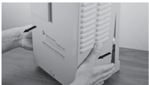
Figura 5 - Tire y saque la parte inferior de la cubierta
