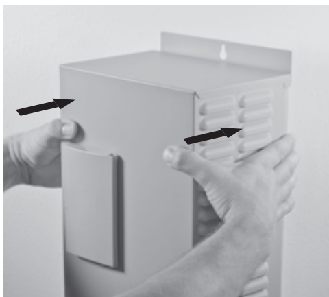
Figura 7 - Volver a colocar la cubierta del variador de frecuencia
